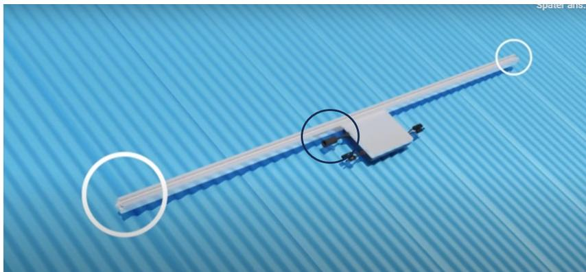
Bohren Sie nun mit einem 10-er Bohrer an den markierten Stellen Löcher in das Dach
