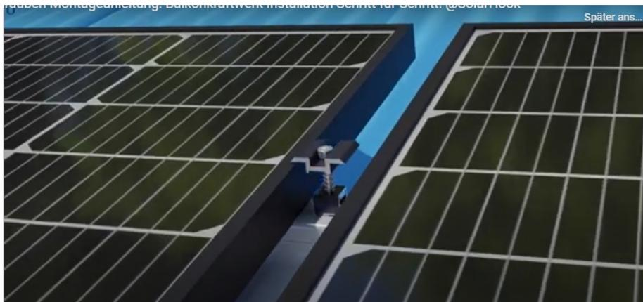
Nun schieben Sie Endklemmen auf beiden Seiten ebenfalls ganz an die Module heran und ziehen Sie fest. – Endklemmen werden mit einem Drehmoment von 10 Nm angezogen.
