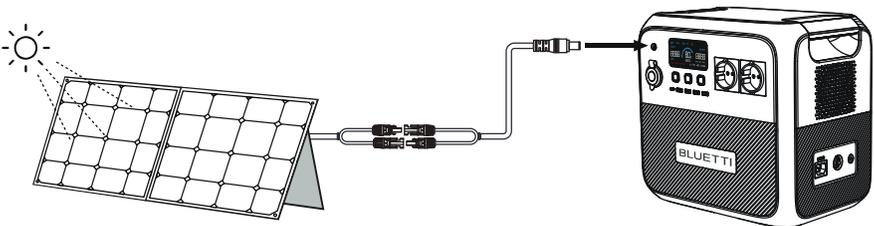
**chtung!** Die Leerlaufspannung von Solarpaneelen darf 40 V nicht überschreiten, da das Gerät andernfalls Schaden nimmt (Hinweis: fällt nicht unter die Garantie)
