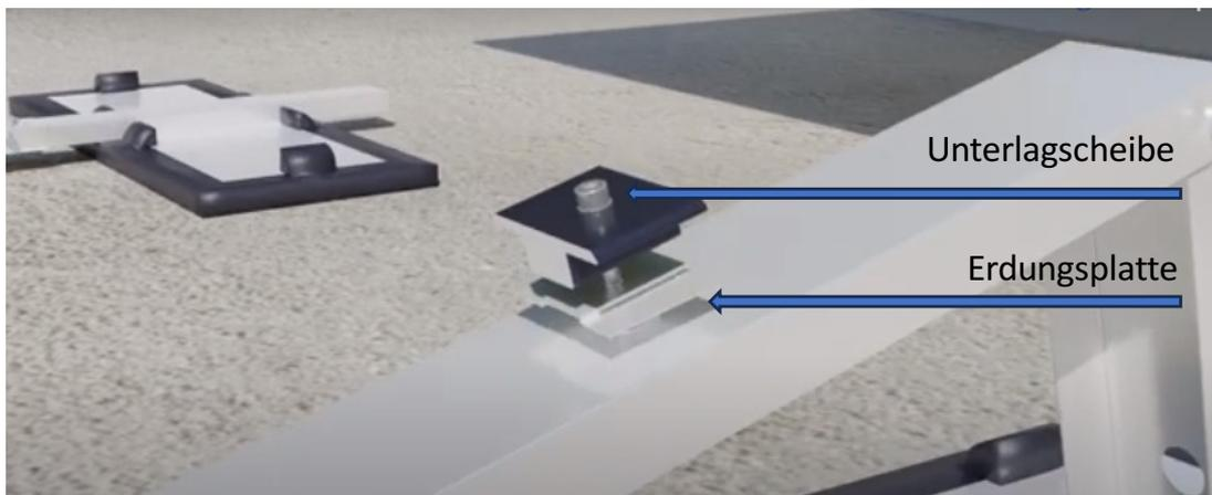
Wenn beide Mittelklemmen vorbereitet sind, können Sie die Module nacheinander auf das mittlere Dreieck auflegen. Achten Sie dabei darauf, dass der Modulrahmen zwischen Mittelklemme und der Erdungsplatte sitzen. Schieben Sie die Module dicht an die Mittelklemmen heran. Wir empfehlen die Module zu Zweit aufzulegen.
