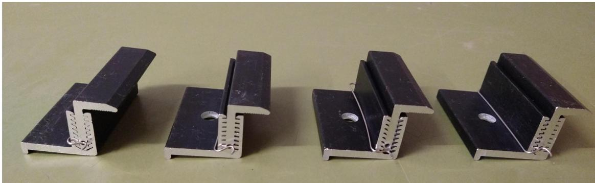
Befestigen Sie nun die Module an den Außenseiten mit diesen Endklemmen Drehmoment 10 Nm.
